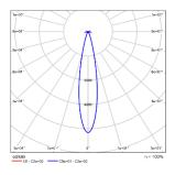
MODEL: ADLN38-LM13A1CCSWT BEAM ANGLE: 18° POWER: 16W
