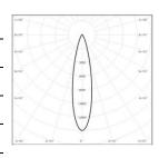
MODEL: AEP5MI-65ML230BK 22° BEAM ANGLE: POWER: 67.39W LUMENS: 3080 Im 14020 cd CBCP: **EFFICACY:** 45.71 lm /W
