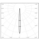
MODEL: AEP5MI-65MLS30BK BEAM ANGLE: 6° POWER: 68.10W **LUMENS:** 3954.8 lm CBCP: 176617 cd 58.07 lm /W **EFFICACY:**
