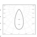
MODEL: AEP5MI-65ML530BK 47° **BEAM ANGLE:** 68.42W POWER: **LUMENS:** 2755.1 lm 3977 cd CBCP: 40.27 lm /W **EFFICACY:**
