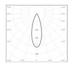
MODEL: AEP5MI-65ML330BK 33° **BEAM ANGLE:** POWER: 68.17W **LUMENS:** 3409.2 lm CBCP: 8398 cd 50.01 lm /W **EFFICACY**:
